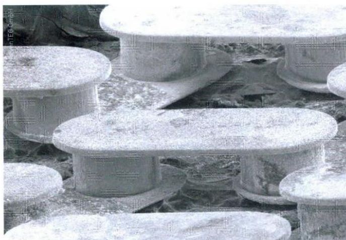
REM-Aufnahme des Generators: Sichtbar sind die einzelnen Thermoelemente aus Bismuth-Telluriden, die nur etwa zwei Zehntel Millimeter hoch sind.
